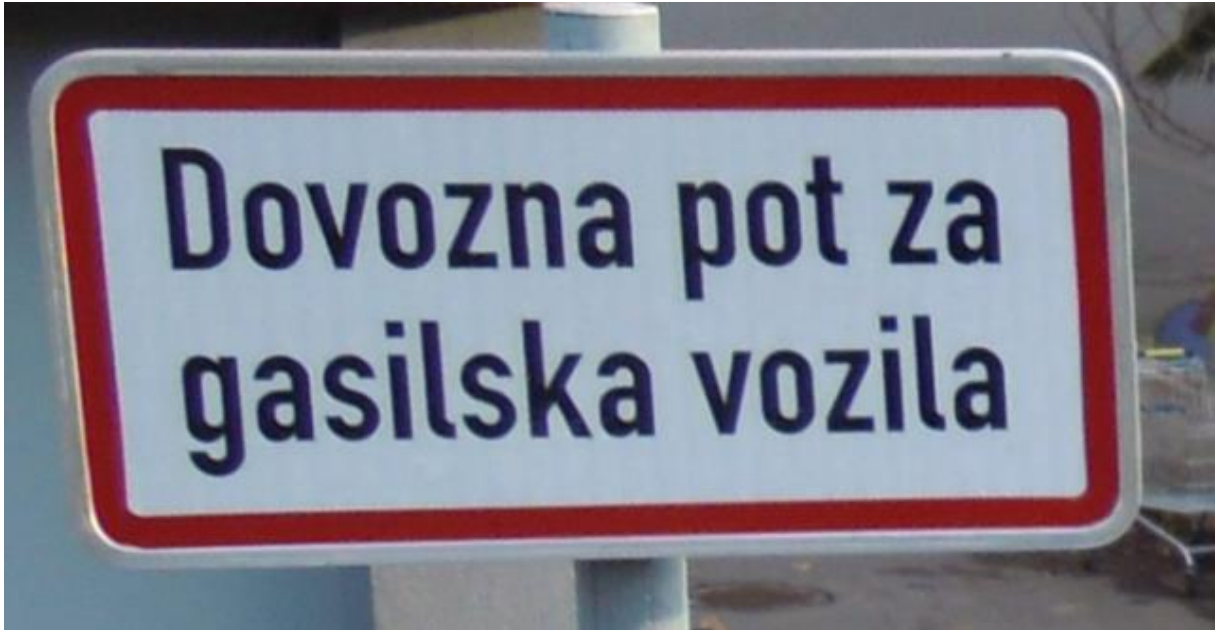
Slika 3: Oblika in dimenzija opozorilne table sta predpisana v standardu SIST DIN 14090
