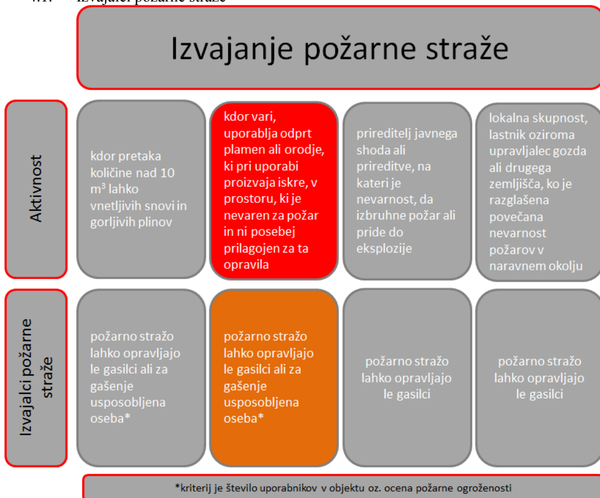
Slika 5: Izvajanje požarne straže v primeru varjenja, uporabe odprtega plamena ali orodja, ki pri uporabi proizvaja iskre, v prostoru, ki je nevaren za požar in ni posebej prilagojen za ta opravila
