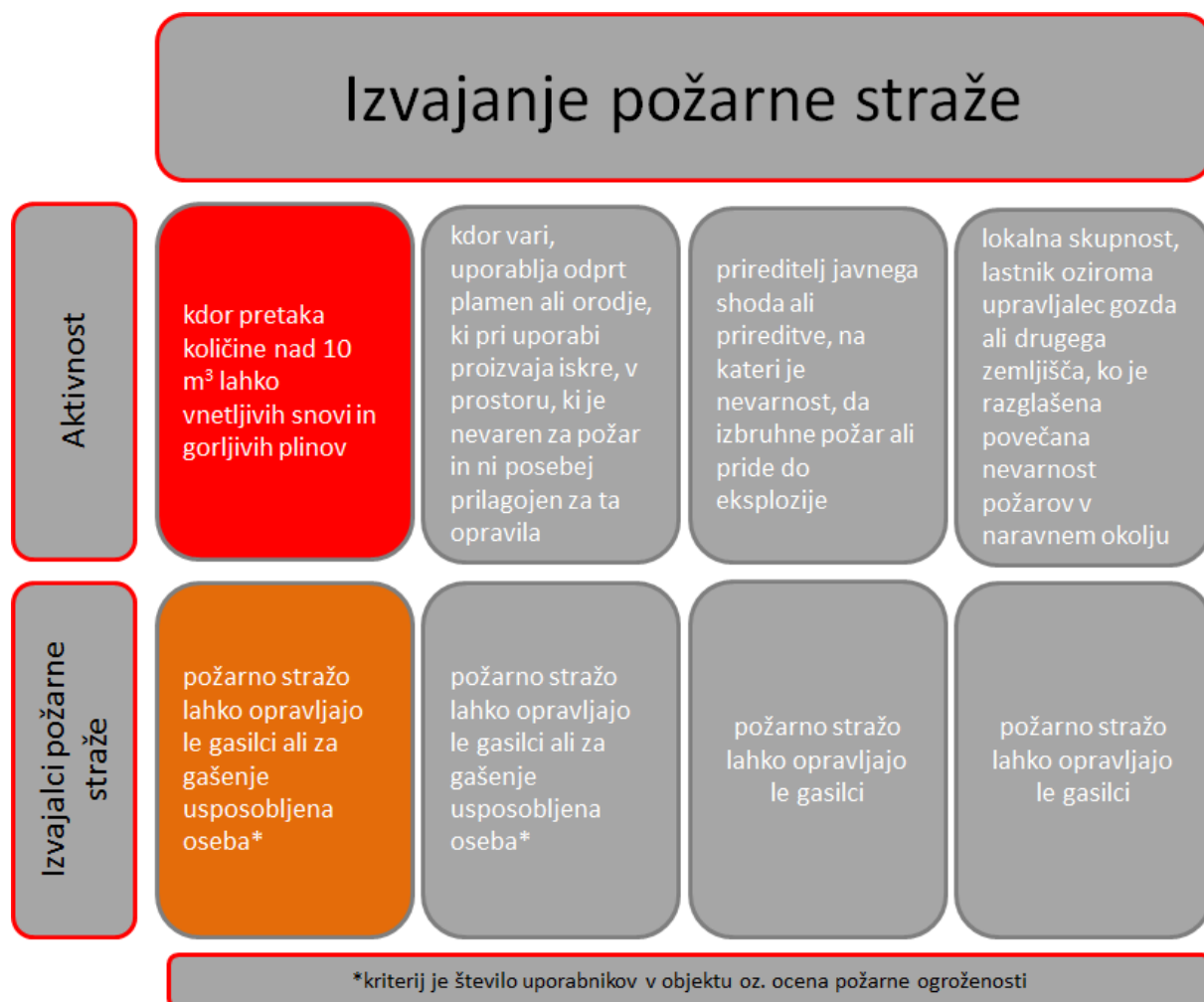
Slika 3: Izvajanje požarne straže v primeru pretakanja vnetljivih tekočin in plinov
