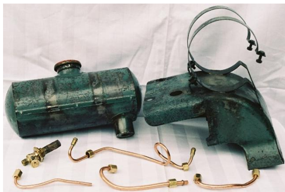
Rezervoar, del ohišja, pipca in cevke za gorivo po restavriranju, foto Boštjan Meglič.
